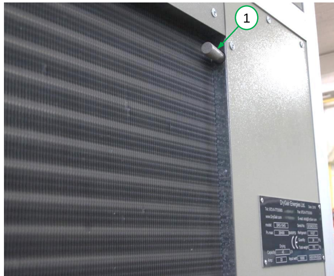
Afbeelding 5-1. Temperatuur- en luchtvochtigheidssensor
